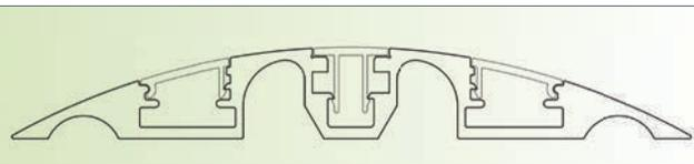
• Pour dissimuler les câbles des moteurs et des cellules photo-électriques • Avec crapaudines et butée centrale intégrées
