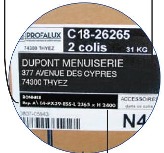
Type de volet, de lame, de manœuvre et dimensions
