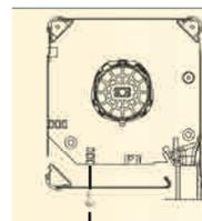
Trappe démontable par-dessous, collée au porteur pour conserver de la rigidité une fois démontée et permettre un remontage plus aisé. Démontage du moteur facilité.
