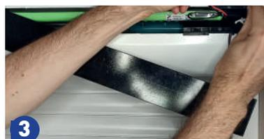
3 BRANCHER ET CLIPPER LA NOUVELLE BATTERIE
