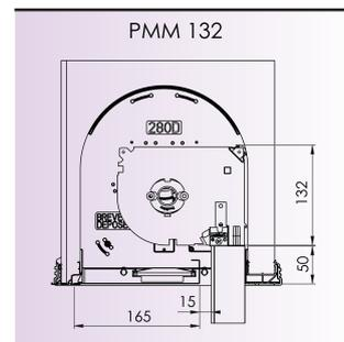
⚠ À la prise de cote, si la cote E est supérieure à 50 mm, rajouter la différence à HSL.
