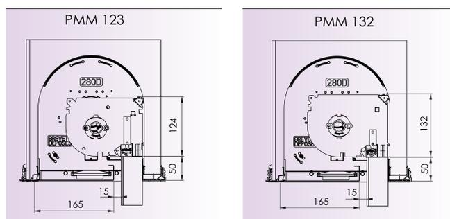
⚠ À la prise de cote, si la cote E est supérieure à 50 mm, rajouter la différence à HSL.
