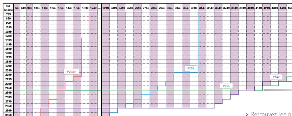
En lame PX40 et PX55, au-delà de LDC 4000mm, ou HSL supérieure à 2450, le volet Presto sera livré tablier non monté
