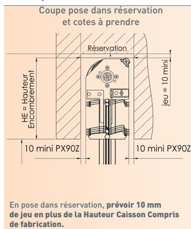
En pose dans réservation, prévoir 10 mm de jeu en plus de la Hauteur Caisson Compris de fabrication.
