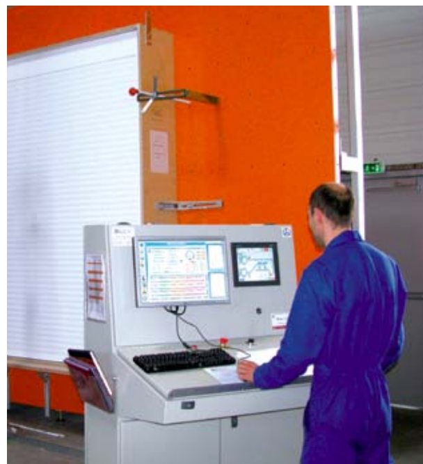
Banc d'essai de résistance au vent
