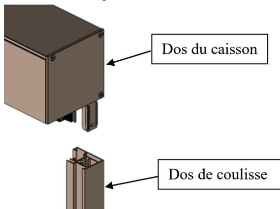
⚠ L'angle de la coulisse doit être à l'angle du caisson.
