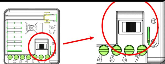
A l'aide d'un tournevis, positionner le commutateur au milieu
