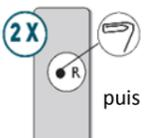
Prendre la télécommande d'un Equipement de l'installation. A l'aide d'un trombone, appuyer **2 fois sur R**, relâcher puis en même temps sur les boutons **Montée** et **Descente**
