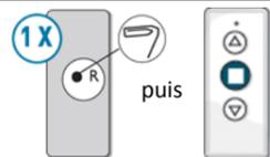
a/ Prendre la télécommande d'un Equipement de l'installation. A l'aide d'un trombone, appuyer 1 fois sur R puis appuyer sur le bouton Stop
