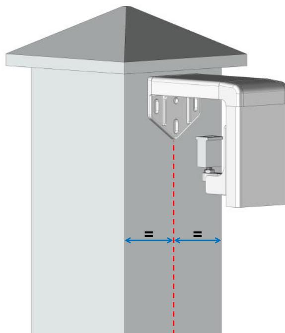
En fixant le guidage haut sur le poteau, serrer les vis provisoirement sans forcer.
