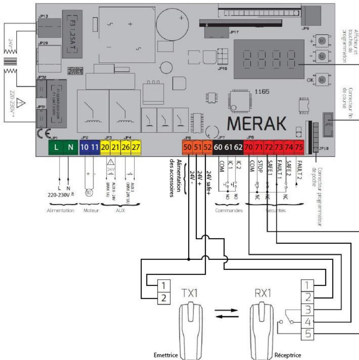
**⚠ Enlever les ponts des sorties utilisées, les autres restent d'origine**
