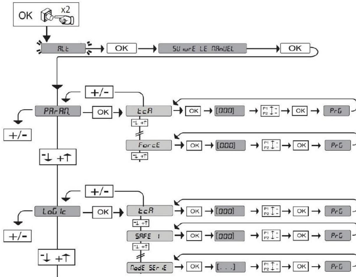
Réglage du temps de fermeture automatique :
