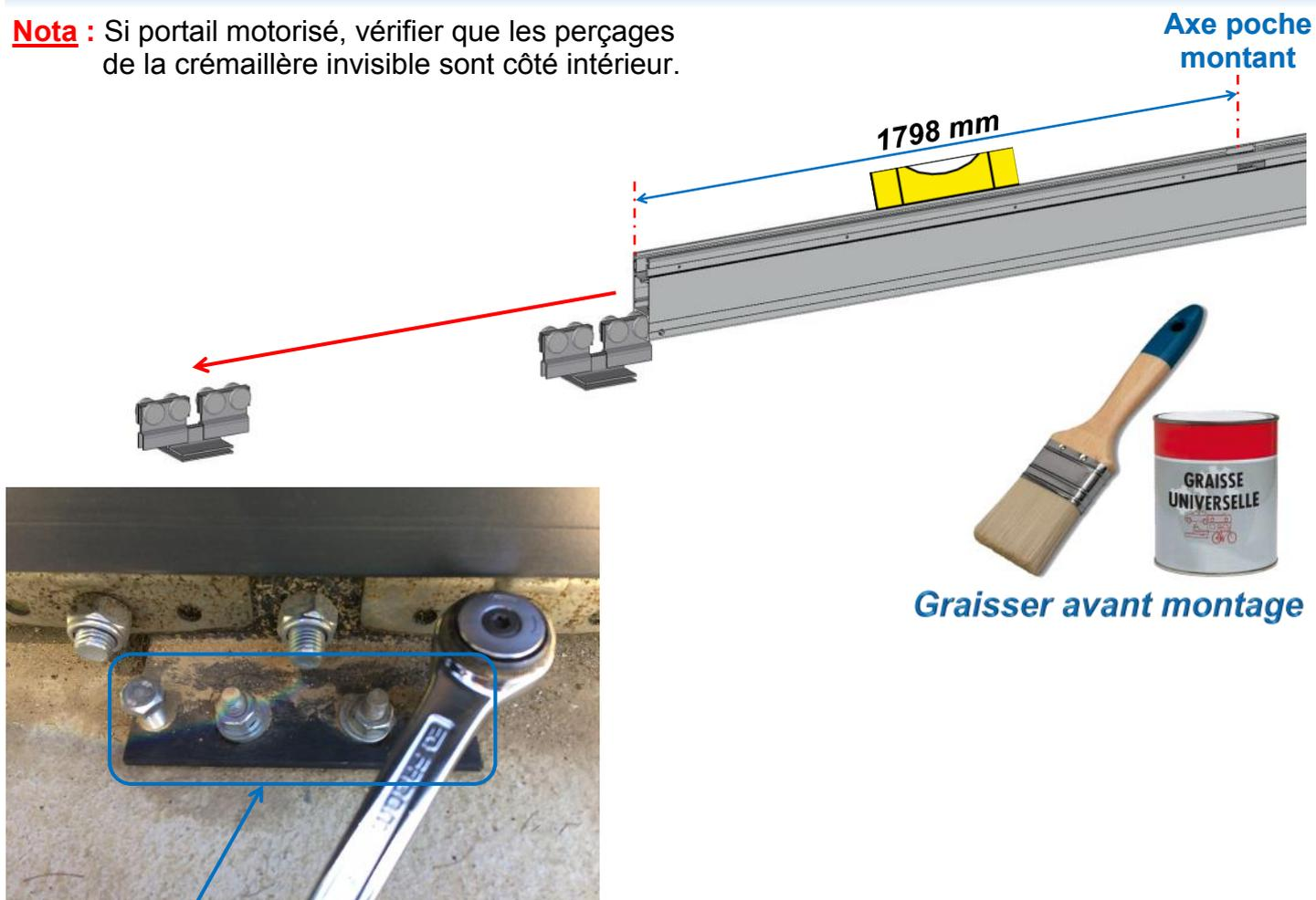
Régler le niveau en serrant les vis d'extrémités (desserrer légèrement les vis du centre).
