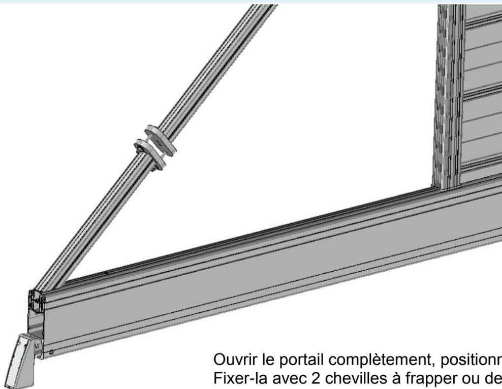
Ouvrir le portail complètement, positionner la butée d'ouverture au sol. Fixer-la avec 2 chevilles à frapper ou des vis adaptées (non fournies).
