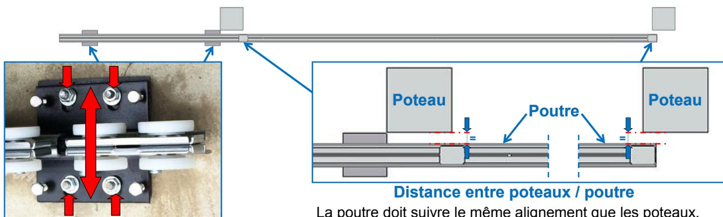
La poutre doit suivre le même alignement que les poteaux. Elle doit être à égal distance entre chacun d'eux. Si besoin de réglage, desserrer les fixations au centre et régler la plaque à l'aide des trous oblongs puis bloquer les vis.
