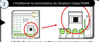
A l'aide d'un tournevis, positionner le commutateur au milieu
