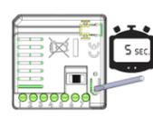
b/ A l'aide d'un tournevis, faire 1 appui de 5 secondes sur le bouton du récepteur
