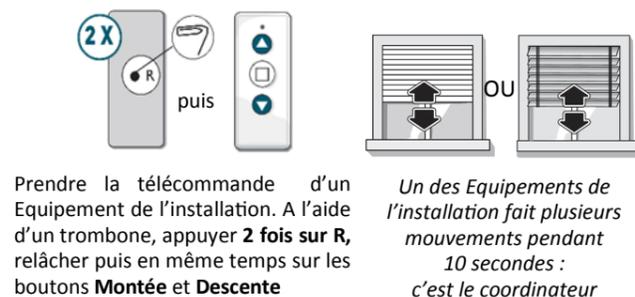
Prendre la télécommande d'un Equipement de l'installation. A l'aide d'un trombone, appuyer **2 fois sur R**, relâcher puis en même temps sur les boutons **Montée** et **Descente**
