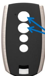
Appuyer 4 secondes simultanément sur les touches 1 et 2 d'une nouvelle télécommande à programmer.
