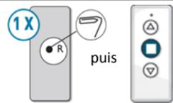
a/ Prendre la télécommande d'un Equipement de l'installation. A l'aide d'un tournevis, appuyer **1 fois sur R** puis appuyer sur le bouton **Stop**
