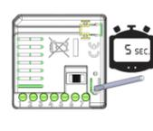
b/ A l'aide d'un tournevis, faire **1 appui de 5 secondes** sur le bouton du récepteur
