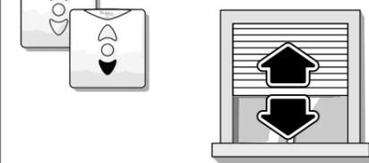
Le volet roulant est réglé sur le 2<sup>ème</sup> émetteur ou sur l'émetteur de commande générale
