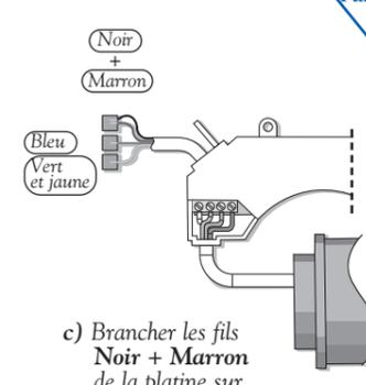
c) Brancher les fils **Noir + Marron** de la platine sur la même borne et alimenter le moteur pendant 90 secondes
