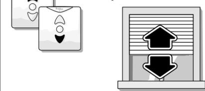
Le volet roulant est supprimé du 2<sup>ème</sup> émetteur ou de la télécommande générale
