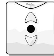
Appuyer sur le bouton **Stop** puis tester les sens "montée descente" sans aller en fin de course. Si le volet monte au lieu de descendre, voir au dos
