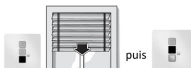
a) Appuyer sur le bouton **Descente** et **Stopper** le BSO à la position désirée.
