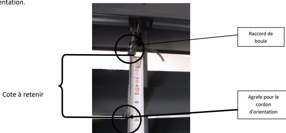
9- Prendre le nouveau tablier, vérifier la cote entre le raccord de boule avant et arrière et la première agrafe du tablier.
