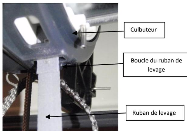
6- Sur le culbuteur, retirer la goupille de maintien du ruban de levage. Désolidariser complètement le ruban de levage du culbuteur.
