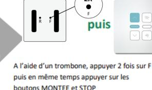
A l'aide d'un trombone, appuyer 2 fois sur F puis en même temps appuyer sur les boutons MONTEE et STOP
