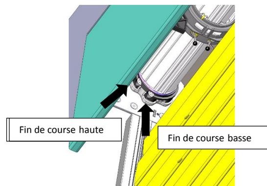
5. Monter le BSO et vérifier s'il s'arrête au bon endroit.
