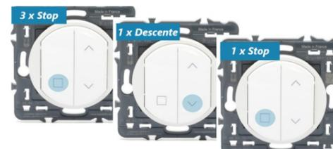
b) Faire 3 appuis sur Stop puis 1 appui sur Descente puis 1 appui sur Stop
