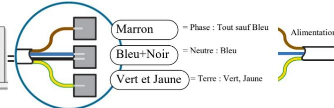
Branchement à réaliser dans le respect de la norme NFC15-100
