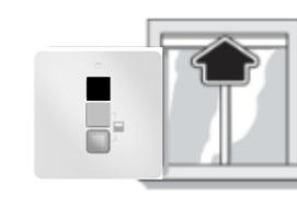
f) Appuyer sur le bouton **Montée** et laisser le BSO s'arrêter de lui-même.
