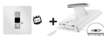
b) Prendre la télécommande générale, déclipser le cache. Appuyer sur le bouton **Stop** et en même temps positionner le commutateur sur **P**. Maintenir **5 secondes le bouton Stop** puis relâcher.
