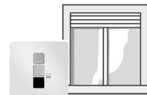
e) Appuyer sur le bouton **Descente** et laisser **4 lames apparentes**.
