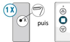
b/ Prendre la télécommande d'un volet du réseau, à l'aide d'un trombone, appuyer **1 fois sur R** puis appuyer sur le bouton **Stop**
