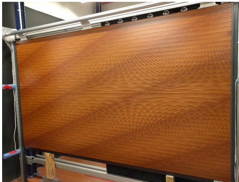
Tablier présentant le défaut visuel
