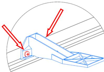
4. Positionner la sous-face dans le coffralux et repérer l'emplacement de la patte de renfort.
