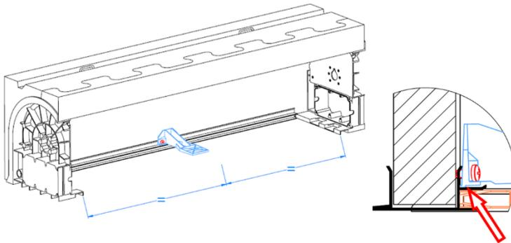
3. Visser la patte de renfort dans le profil extérieur. **Vis préconisée TCB 4.3X19.**
