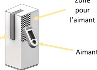
Sur le Capteur, positionner l'aimant sur la zone pour l'aimant pendant **15 secondes** : le voyant devient vert puis **rouge**. Retirer l'aimant
