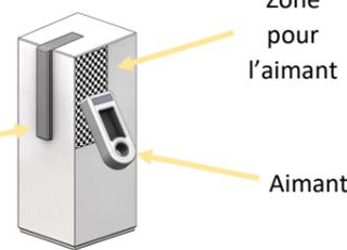
b/ Sur le capteur positionner l'aimant sur la zone pour l'aimant, jusqu'à ce que le voyant devienne **rouge fixe**
