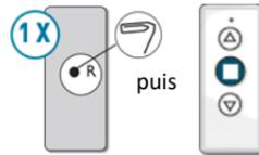
a/ Prendre la télécommande d'un volet du réseau, à l'aide d'un trombone, appuyer **1 fois sur R** puis appuyer sur le bouton **Stop**
