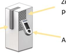
Sur le capteur, positionner l'aimant sur la zone pour l'aimant, jusqu'à ce que le voyant devienne **vert**
