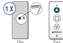
b) Avec la télécommande du volet à ajouter, à l'aide d'un trombone, appuyer 1 fois sur R au dos de la télécommande, puis sur le bouton Montée
