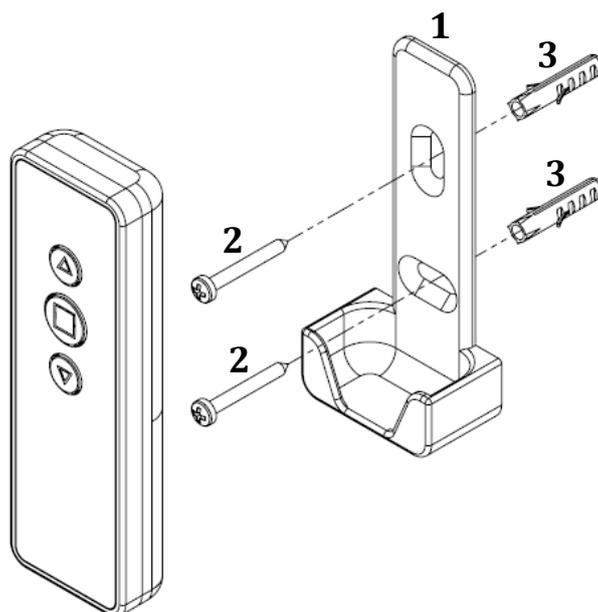
Dissocier la télécommande de son support (1) pour permettre de fixer celui-ci au mur grâce aux 2 vis (2) et aux 2 chevilles (3) fournies puis remettre la télécommande dans son support.
