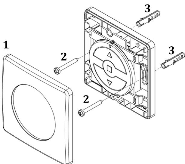
A l'aide d'un tournevis, déclipser délicatement le plastron avant (1) pour permettre de fixer la télécommande au mur grâce aux 2 vis (2) et aux 2 chevilles (3) fournies puis remettre le cache.
