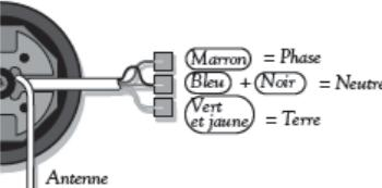
g/ Brancher le fil noir avec le fil bleu du moteur sur le fil Neutre de l'alimentation
