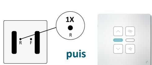
a/ Prendre la télécommande d'un équipement de l'installation. Appuyer **1 fois** sur R au dos de la télécommande, puis sur le **bouton Stop**.
