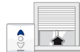
e/ Appuyer sur le bouton **Montée** et laisser le Volet / BSO / Store **remonter de 100MM**.
