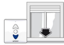
e/ Appuyer sur le bouton **Descente** et laisser **4 lames apparentes**.
