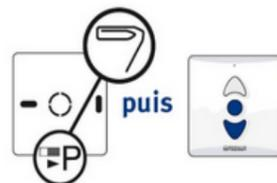
a/ Positionner le commutateur sur **P** puis appuyer en même temps sur les boutons **Stop** et **Descente**.
