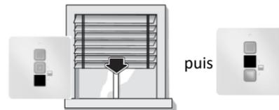
a) Appuyer sur le bouton **Descente** et **Stopper** le BSO à la position désirée. Pour le Store le **Stopper** à **10mm** du sol.
