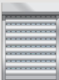
Le volet roulant se déplace jusqu'à la position enregistrée en lames ajourées.
