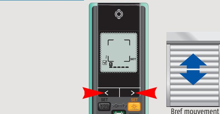
Sélectionner votre moteur à l'aide de < ou >. Le volet fait un va et vient : le moteur est sélectionné. Si la télécommande clignote rouge, le moteur n'est pas présent ou alimenté, passer au suivant à l'aide de < ou >
