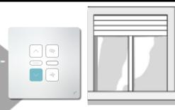
a) Descendre le volet à l'aide de la télécommande et laisser 4 lames apparentes
