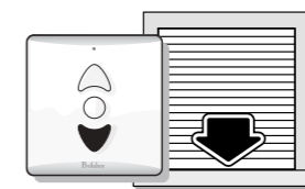
f) Appuyer sur le bouton descente et laisser le volet s'arrêter de lui-même
