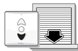
d) Appuyer sur le bouton descente et laisser le volet s'arrêter de lui-même
