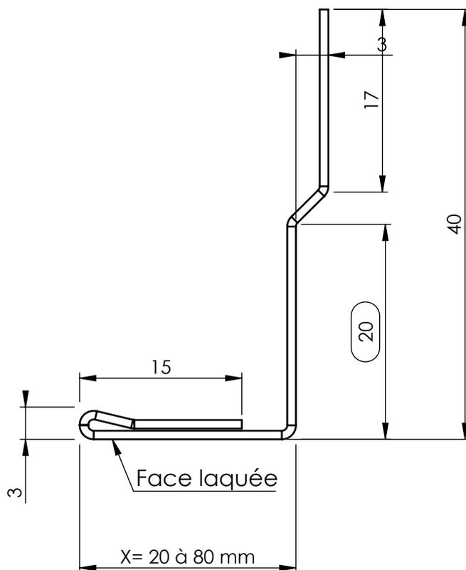
Fixation par vis autoforeuses 3.5x9.5 référence VIS-VDB395
