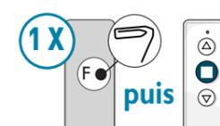
A l'aide d'un trombone, appuyer 1 fois sur **F** au dos de la télécommande puis sur le bouton **Stop**
