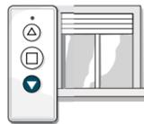
a) Descendre le volet à l'aide de la télécommande et laisser 4 lames apparentes
