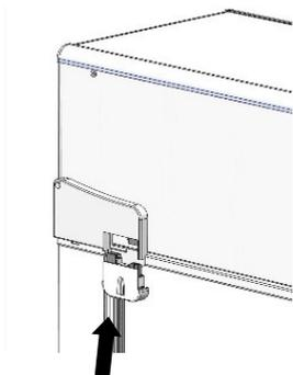
Dans le sachet de colisage, prendre la prise Impulse et la clipper au dos du caisson
