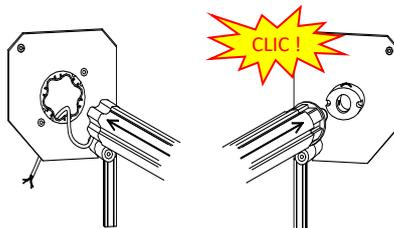
Suivant le type de moteur, insérer la tête de moteur dans son support (verrouillage par clip) ou dans la joue (verrouillage par goupille).
