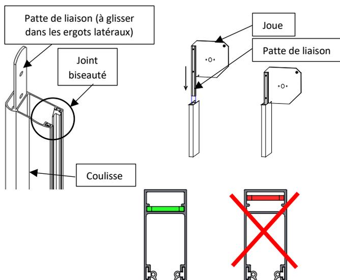
NB : en coulisses C63, vérifier le sens d'enroulement du tablier pour positionner les coulisses dans le bon sens.
