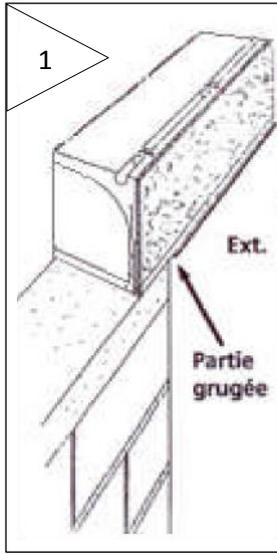
Mise en place du coffre demi-linteau face extérieure alignée sur la face extérieure du mur brut de maçonnerie.
