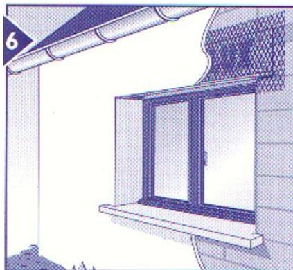
Avant finition extérieur, prévoir un treillis dans le cas d'un enduit traditionnel. Ce treillis sera débordant de 15 cm de chaque côté et sur le haut du coffre.
