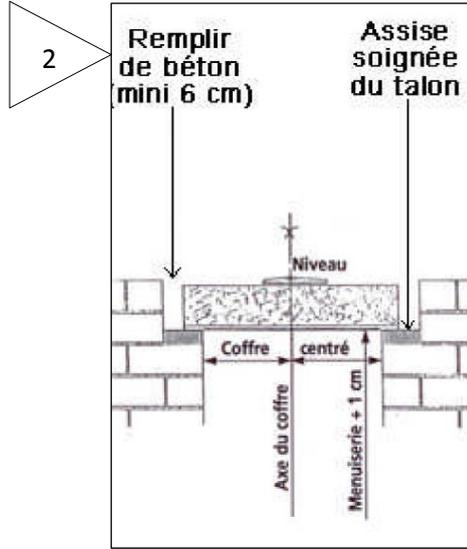
Préparation de l'assise du coffre demi-linteau à l'aide de 4 planches tenues par serre-joints. Régler le niveau dans les deux sens.
