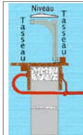
Le coffre demi-linteau n'est pas un élément porteur, il faut donc prévoir un étayage en conséquence tous les 60 à 70 cm avant de couler le chaînage, ou le linteau ou la dalle.
