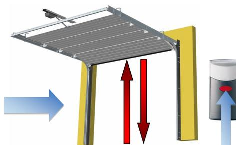
Effectuer et confirmer l'apprentissage (appuyer sur le bouton du boîtier de commande pour lancer 1 cycle d'ouverture/fermeture de la porte)
