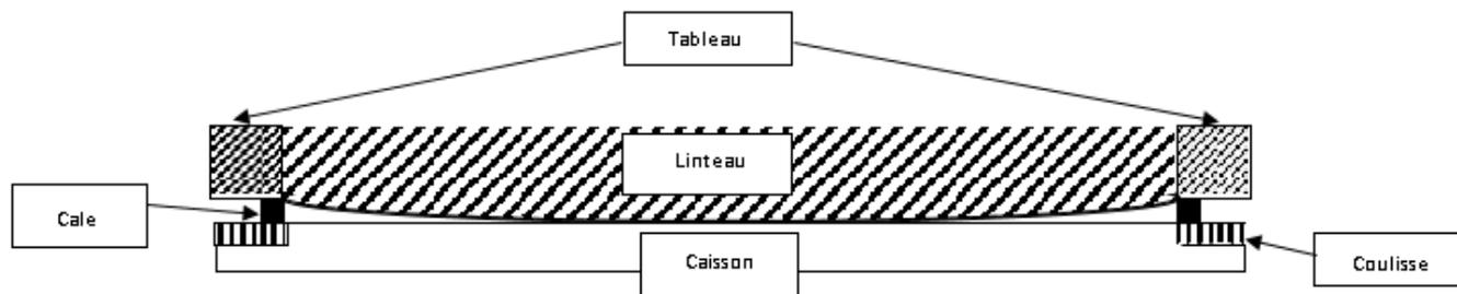
Vérifier que le linteau contre lequel la tôle arrière va s'appuyer est net de toute excroissance de type « gratons » de crépi ou béton.
