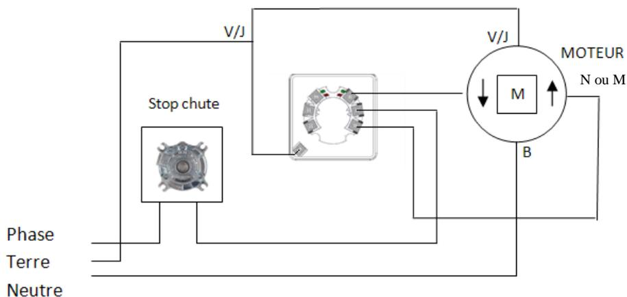
Si la commande « Montée » effectuée une « Descente », il faut inverser les fils Marron et Noir (hors tension)
