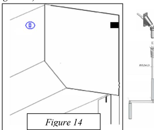
**!** La manivelle est une manivelle de secours et ne doit être utilisée qu'en cas de coupure d'alimentation. Dans le cas échéant, cela risque une détérioration des fins de course du moteur.
