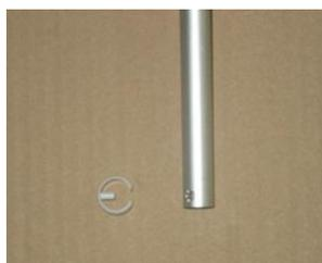
Retirer la vis qui se situe à l'extrémité du 6 pans et retirer la bague de la manivelle
