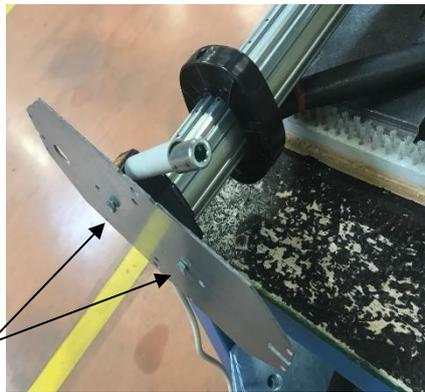
13- Récupérer la roue et la couronne du moteur défectueux et les replacer sur le nouveau moteur.
