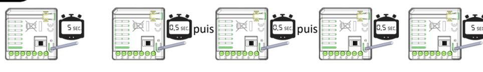
b/ A l'aide d'un tournevis, faire 1 appui de 5 secondes sur le bouton du récepteur
