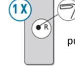
c/ Prendre la télécommande d'un Equipement à ajouter, appuyer **1 fois sur R** puis appuyer sur le bouton **Montée**
