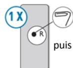
a/ Prendre la télécommande d'un Equipement de l'installation. A l'aide d'un trombone, appuyer **1 fois sur R** puis sur le bouton **Montée**
