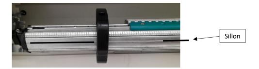
b) Tracer un point à 210 mm de l'extrémité de l'axe sur ce sillon.
