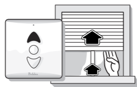
b) Appuyer sur le bouton montée Si besoin aider le tablier
