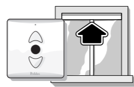
c) Stopper le volet à la position de fin de course haute désirée ou le laisser s'arrêter de lui-même
