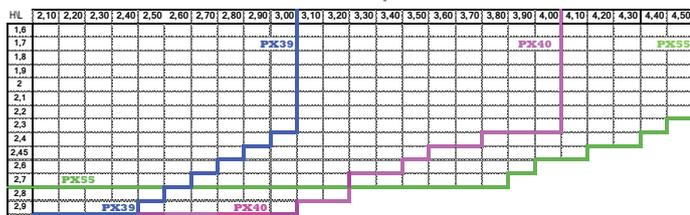
En lame PX55, au-delà de LDC 4000mm, le volet Presto sera livré tablier non monté
